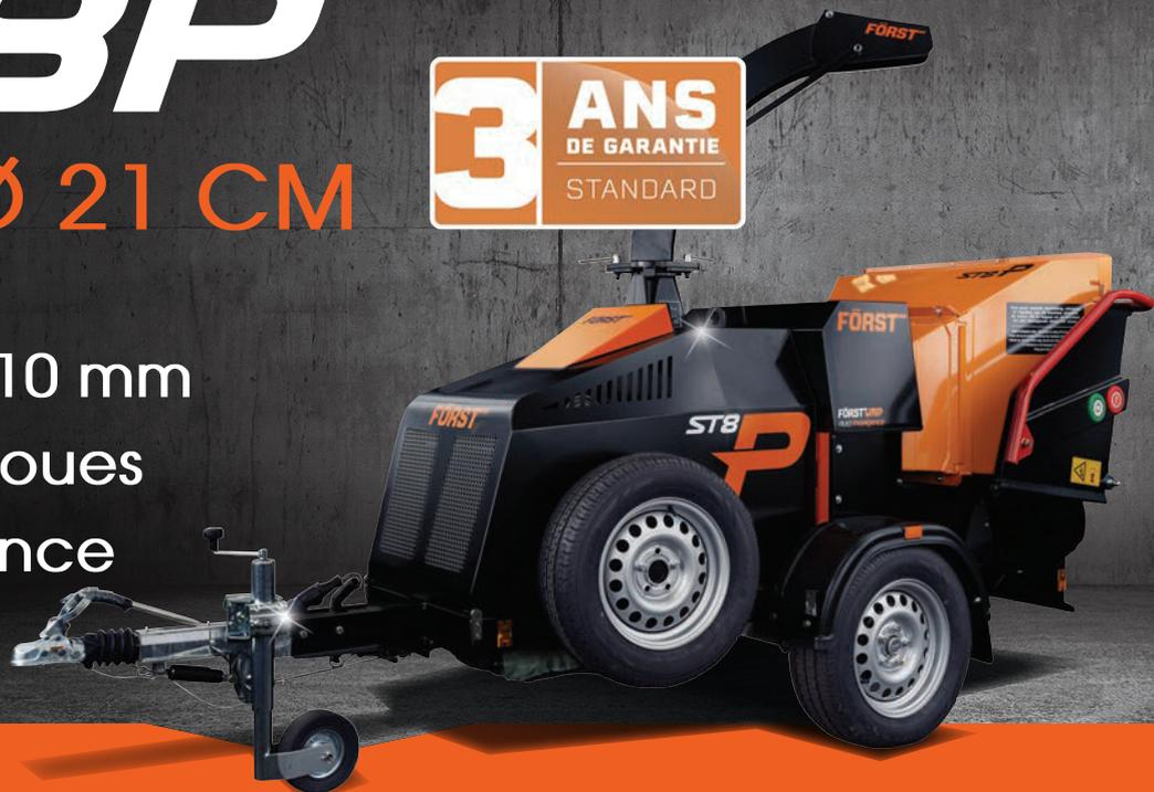
Soumis à des règles antipollution très strictes, les moteurs diesel sont de plus en plus complexes à fabriquer. Le broyeur de branches ST8P FÖRST est doté d'un moteur Kubota essence de 57 cv. Émettant d'origine moins de particules fines, il
