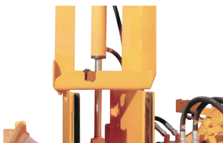
Un vérin hydraulique exerce une pression de 800 kg sur le rouleau supérieur d'alimentation.
