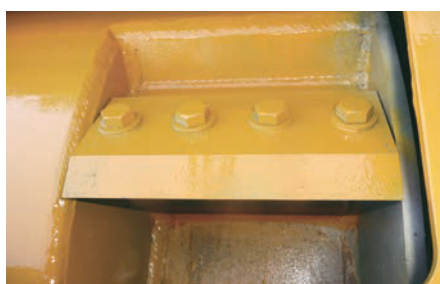
Les couteaux du tambour sont faciles d'accès et simples à démonter.
